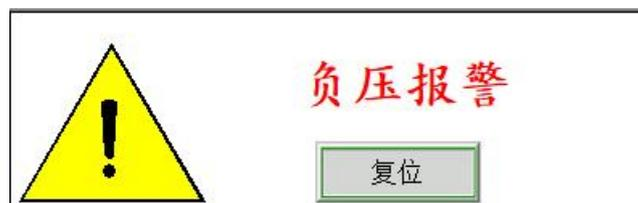
此时需点击复位按钮，检查进油口是否堵塞，清理 Y 型过滤器滤芯
