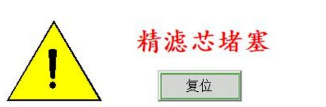
此时需点击“复位”按钮，停机对应更换预过滤器滤芯或超微过滤器滤芯
